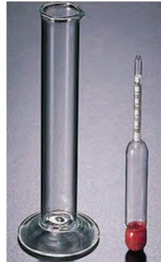
Слика 3.25. Уринометар и стаклен цилиндар
